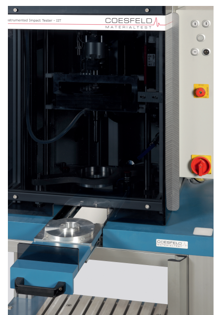
Auch die Probenzuführung zum instrumentierten Durchstoß (ISO 6603) erfolgt schnell und ergonomisch. © Coesfeld
