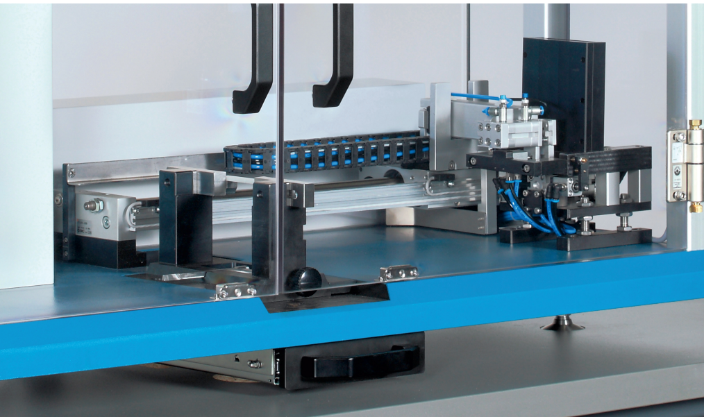
Die Probenzuführung zum Charpy-Pendelschlagversuch (ISO 179) erfolgt über eine Schublade bequem und sicher automatisch. © Coesfeld
